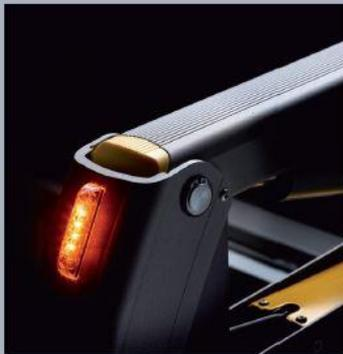
Das weltweit einzigartige Design der spezialgefertigten Hubarme verdankt der AL1 dem Einsatz von Aluminiumprofilen.
