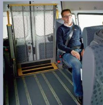
Das durchsichtige Plattformdesign des Linearliftes sorgt für eine exzellente Sicht nach hinten.
