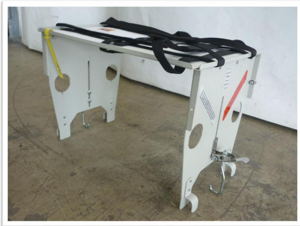
Bieten hier eine gebrauchte Geräteplatte Ferno Pac-Rac 274-2 zum Kauf an. Die Pac-Rac Geräteplatte Modell 274-2 dient für den sicheren Halt von Notfallgeräten während des Transportes eines Patienten auf der Krankentrage außerhalb des Fahrzeuges.
