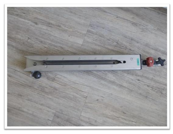
Gebrauchte Bodenhalterung von Utila inkl. AMF-Umbau. Passend für Airline-Schienen zur Arretierung von Tragestühlen im Smartfloor-Boden im Fahrzeug.
